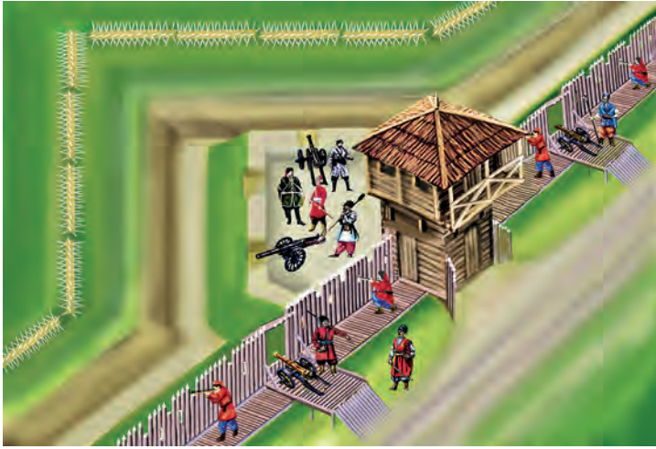
Іл. 16. Гострокіл, рублена вежа, фланкуючий земляний больверк і рів з колодами-рогатками батуринської фортеці та їхня оборона гарматним і мушкетним вогнем у 1708 р. Комп'ютерна графіка С. Дмитрієнка за реконструкціями О. Бондаря, 2019 р.
