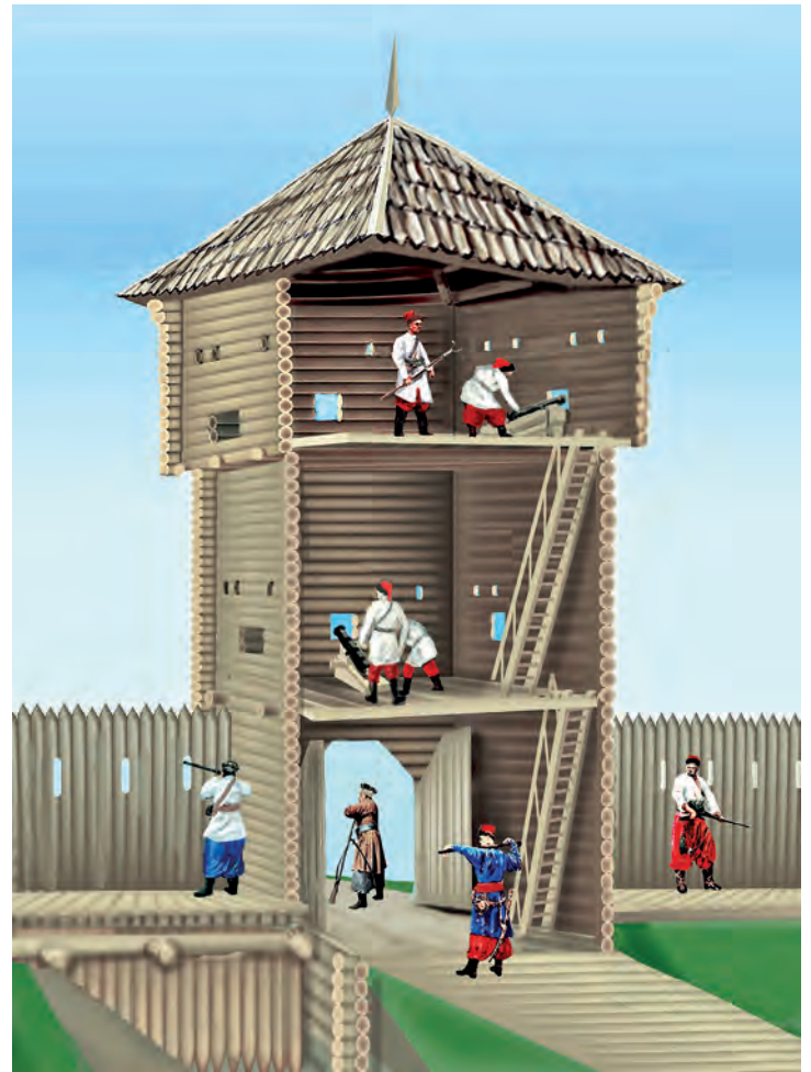
Іл. 17. Гострокіл і перетин зрубної надбрамної башти фортеці гетьманської столиці. Комп'ютерна графіка С. Дмитрієнка за реконструкціями О. Бондаря, 2019 р.
